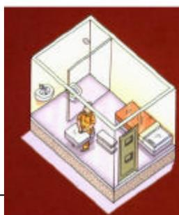
Cada cela terá cama, banco e prateleiras de concreto fixados nas paredes e no chão, além de colchão à prova de fogo. Não haverá tomadas elétricas. A área do banheiro terá pia, bacia sanitária e um buraco no teto, por onde sairá a água do banho.
