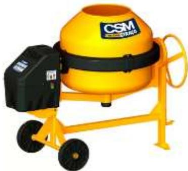
**Marca.:** CSM**Capacidade do tambor:** 400 Litros**Capacidade de mistura:** 315 Litros**Número aproximado de ciclos/hora:** 15**Produção horária aprox.:** 4,7m<sup>3</sup>**Rotação do tambor:** 26 RPM**Potência do motor:** 2 cv 4 polos**Tensão monofásica:** 220v**Frequência:** 60 Hz**Transmissão por correia tipo "V":** A44**Peso:** 160Kg**Dimensões (CxLxA):** 1.855 x 1043 x 1.460 mm
