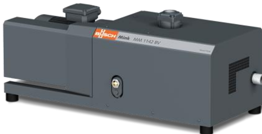
Figura 1 - Foto Ilustrativa - Bomba de vácuo utilizada no sistema de esgoto a vácuo do Conselho da Justiça Federal: Bomba Busch Mink MM 1142 BV - Modelo: MM1142BV, 170m 3 /h, Motor 220/380 60Hz.
